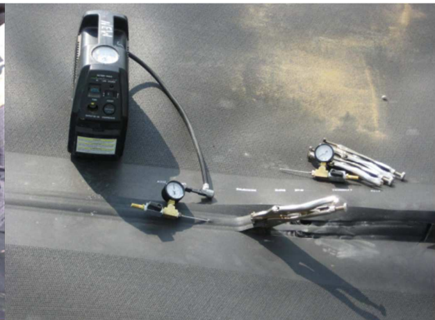
Prueba de succión en soldadura por extrusión
