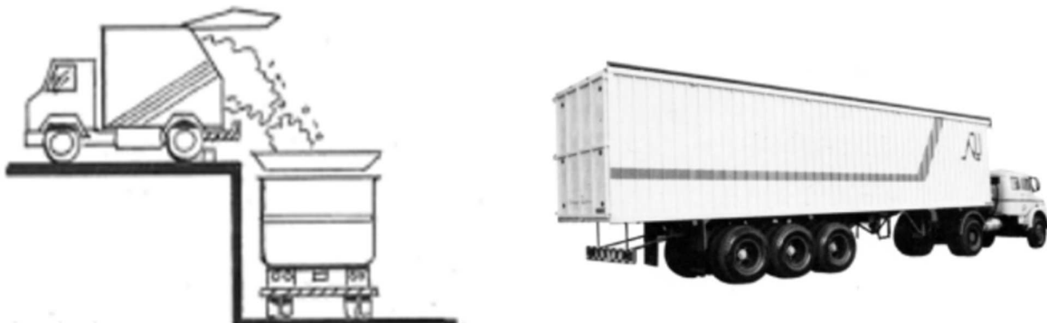
Figura 5-7: ET con transferencia directa sin compactación[14] y Figura 5-8: Camión semirremolque [14]
