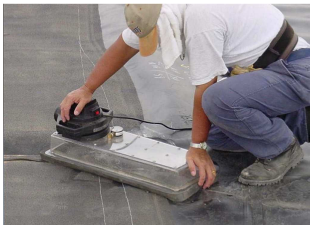
Prueba de succión en soldadura por extrusión
