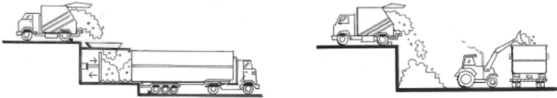
Figura 5-7: ET con transferencia directa sin compactación[14] y Figura 5-8: Camión semirremolque [14]
