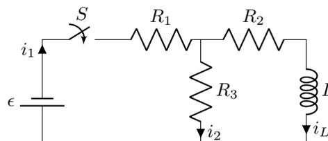
**Ejercicio 2** En el circuito que se muestra en la figura, el interruptor ha estado en la posición a durante largo tiempo. Ahora se conecta a b. (a) Calcule la frecuencia de la corriente oscilatoria resultante. (b) ¿Cuál será la amplitud de las oscilaciones de la corriente? (c) ¿Cuánto tiempo después de que la energía magnética sea un máximo volverá a ser un máximo otra vez?
