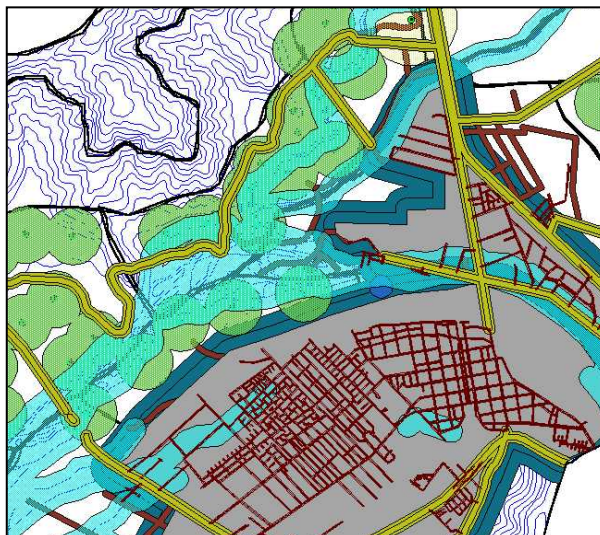
Figura 3.2.17. Cálculo de áreas de influencia. Las bandas en tonalidades verde y celeste indican anillos o corredores predefinidos por el usuario.
