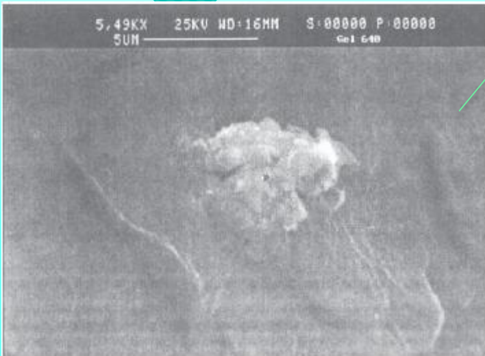
Figura 10. Micrografía de un ojo de pescado de la película 640, obtenida por SEM.
