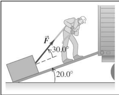
Un hombre arrastra hacia arriba un baúl por la rampa de un camión de mudanzas. La rampa está inclinada  $20.0^\circ$  y el hombre tira con una fuerza  $\vec{F}$  cuya dirección forma un ángulo de  $30.0^\circ$  con la rampa.
