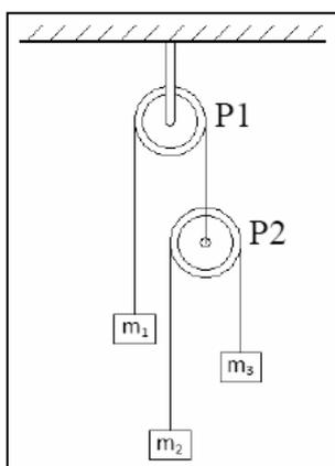
En el sistema que se muestra en la figura,  $P1$  y  $P2$  son dos poleas sin fricción y sin masa. Alrededor de  $P1$ , pasa una cuerda que está unida a un objeto de masa  $m_1$  en uno de sus extremos y a la polea  $P2$  en el otro. La cuerda que pasa alrededor de  $P2$  tiene unida a sus extremos dos objetos de masa  $m_2 = 2m_1$  y  $m_3 = 3m_1$ . Ambas cuerdas son inextensibles y de masa despreciable. Calcula el módulo de la aceleración del objeto de masa  $m_1$ .
