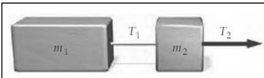
Dos bloques de masas  $m_1$  y  $m_2$  conectados entre sí por una cuerda ideal se aceleran uniformemente sobre una superficie sin rozamiento como se muestra en la figura. Dibuja el diagrama de fuerzas para cada uno de los bloques y expresa la
