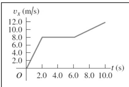
Un objeto de  $2.75\text{ kg}$  se mueve en línea recta. La figura muestra una gráfica de la velocidad de este objeto en función del tiempo.
