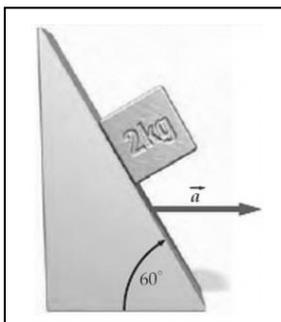
Un bloque de  $2\text{ kg}$  descansa sobre un plano inclinado  $60^\circ$  que se traslada con aceleración  $\vec{a}$  hacia la derecha de tal modo que la masa permanece estacionaria con relación al plano. El contacto entre el bloque y la superficie carece de fricción.
