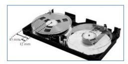
La cinta de un cassette de video VHS estándar tiene una longitud  $L=246\ m$ ; su duración en funcionamiento es de 2 horas. Al comienzo, el carrete que contiene la cinta tiene un radio externo de, aproximadamente,  $R=45\ mm$ , mientras que el radio interno es  $r=12\ mm$  aproximadamente. En cierto punto de su recorrido, ambos carretes tienen la misma velocidad angular. Calcula esa
