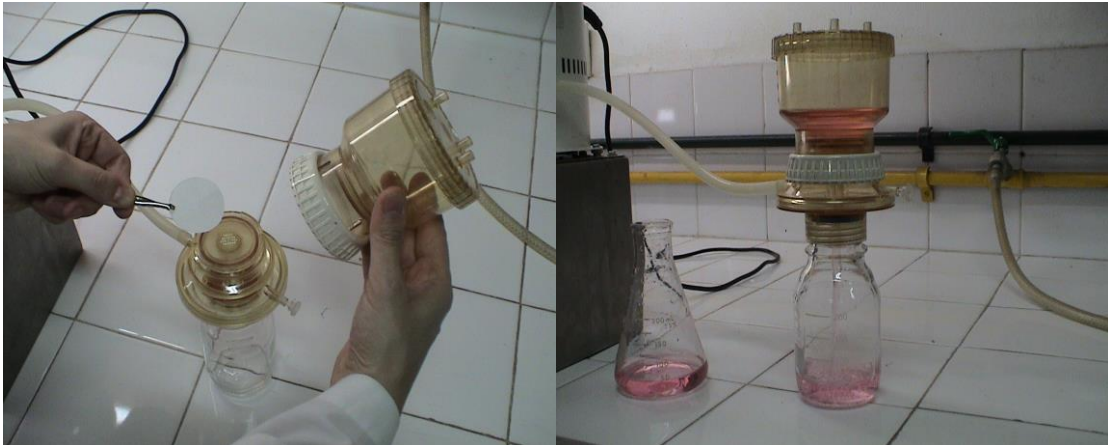
Figura 22: Colocación del filtro y proceso de filtración por vacío
