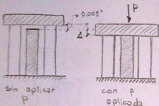
Como se puede ver, si el acero se comprime una distancia  $\Delta$ , el aluminio se comprime  $\Delta + 0.005$ .
