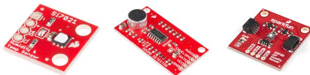
De izquierda a derecha: Sensor Si7021, Sensor de sonido, Sensor SGP30
