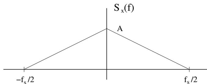
El filtro pasabajos inicial debería tener frecuencia de corte en  $f_s/2$  para evitar solapamiento en la señal final del sistema. Como la señal tiene ese ancho de banda no será afectada por este filtro y su espectro será igual.
