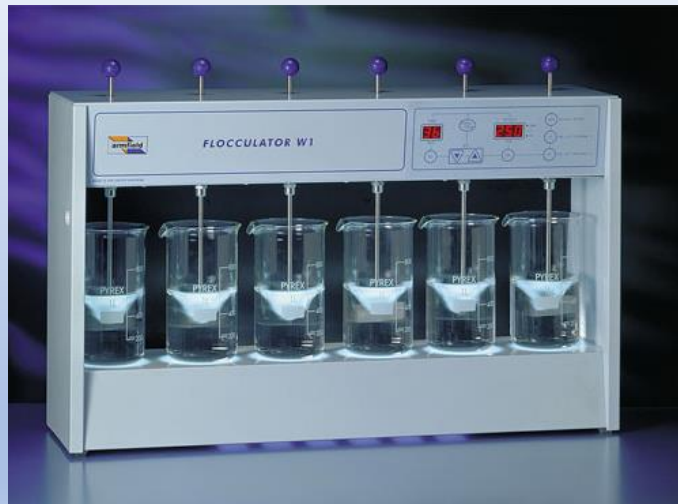
Test de Jarras para optimizar la dosificación y las condiciones de mezcla
