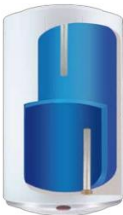
Figura 2.4-12: Doble sistema de protección anódica anticorrosión [43]
