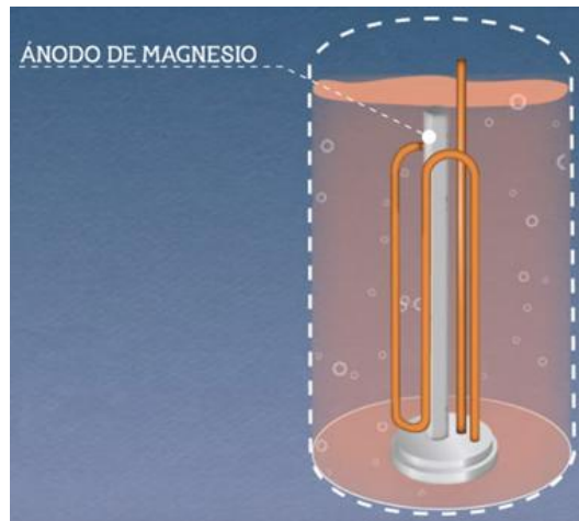
Figura 2.4-9: Ubicación normal del ánodo de sacrificio [51]
