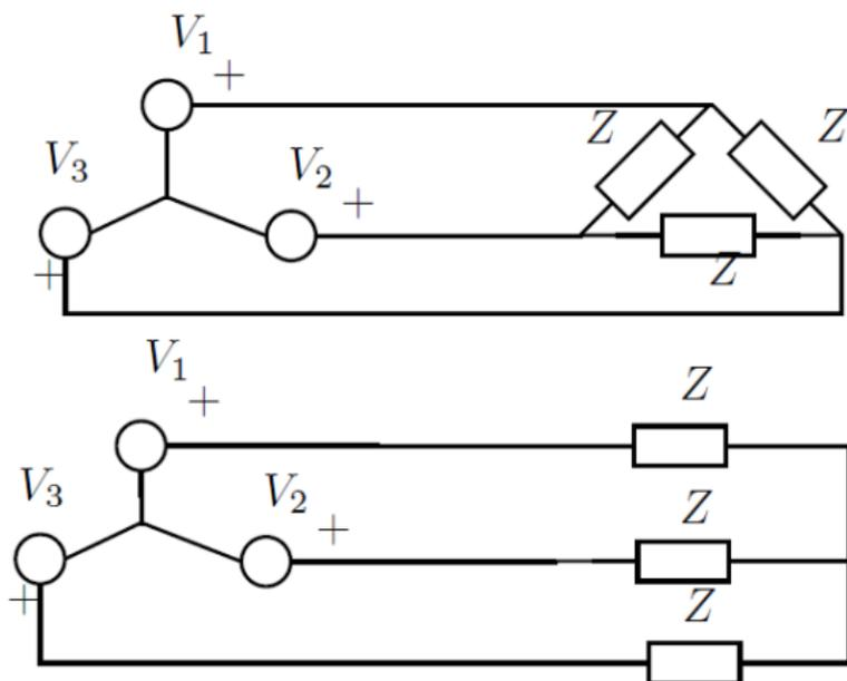
Se tiene una carga trifásica que puede conectarse en estrella o triángulo.
