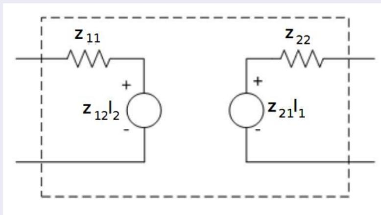
$$\begin{bmatrix} V_1 \\ V_2 \end{bmatrix} = \begin{bmatrix} z_{11} & z_{12} \\ z_{21} & z_{22} \end{bmatrix} \begin{bmatrix} I_1 \\ I_2 \end{bmatrix}$$
