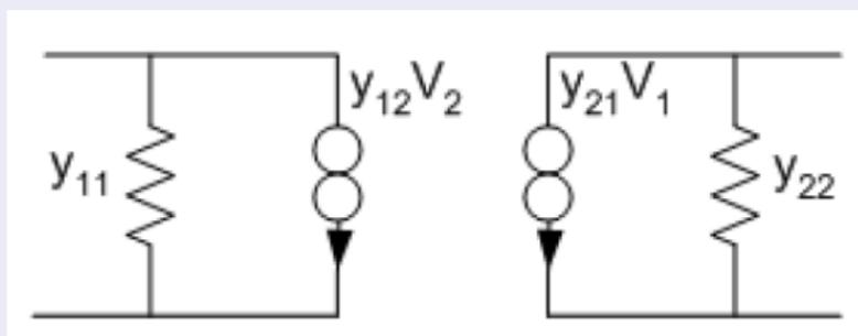
$$\begin{bmatrix} I_1 \\ I_2 \end{bmatrix} = \begin{bmatrix} y_{11} & y_{12} \\ y_{21} & y_{22} \end{bmatrix} \begin{bmatrix} V_1 \\ V_2 \end{bmatrix}$$
