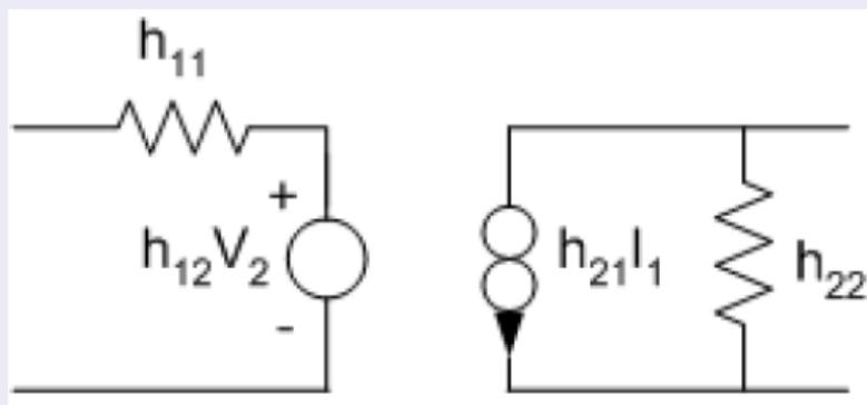
$$\begin{bmatrix} V_1 \\ I_2 \end{bmatrix} = \begin{bmatrix} h_{11} & h_{12} \\ h_{21} & h_{22} \end{bmatrix} \begin{bmatrix} I_1 \\ V_2 \end{bmatrix}$$
