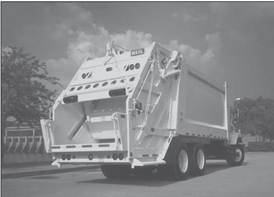
c) El vehículo de carga trasera se utiliza para la recolección habitacional. (Foto cortesía de Heil Environmental)
