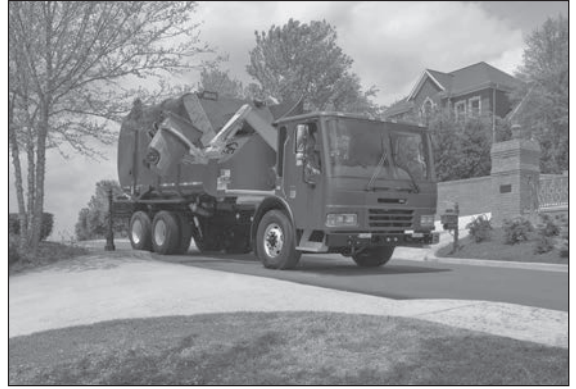
b) Este vehículo de carga lateral es comúnmente utilizado para la recolección habitacional. (Foto cortesía de Heil Environmental)
