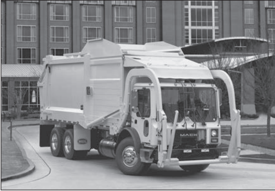
a) Este vehículo de carga frontal es comúnmente utilizado para la recolección comercial. (Foto cortesía de Heil Environmental)
