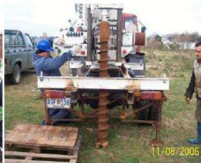
Figura 7: Perforadora rotatoria
