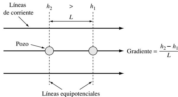
**FIGURA 5.29.** Una red de flujo bidimensional consistente en líneas de corriente y líneas equipotenciales. Si dos pozos coinciden en la misma línea de corriente, el gradiente es justamente  $\Delta h/L$ .
