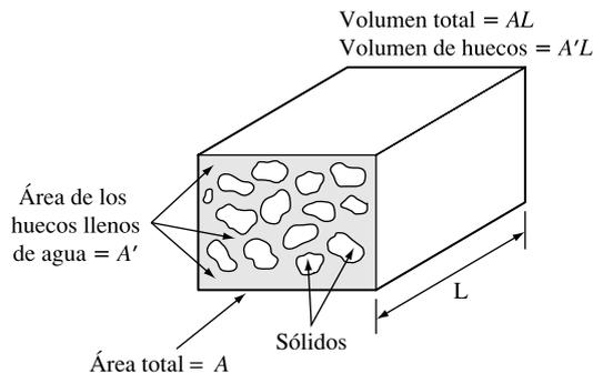
**FIGURA 5.33.** La sección capaz de dejar pasar el agua,  $A'$ , es menor que la sección total del acuífero  $A$ .
