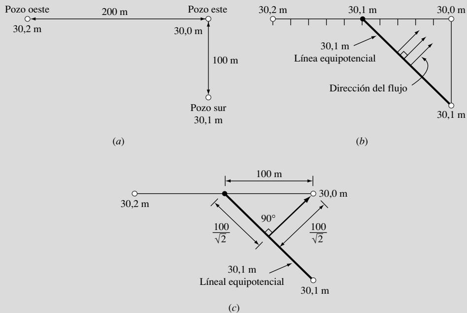
**FIGURA 5.31.** Cálculo del gradiente para el campo de pozos del Ejemplo 5.11.
