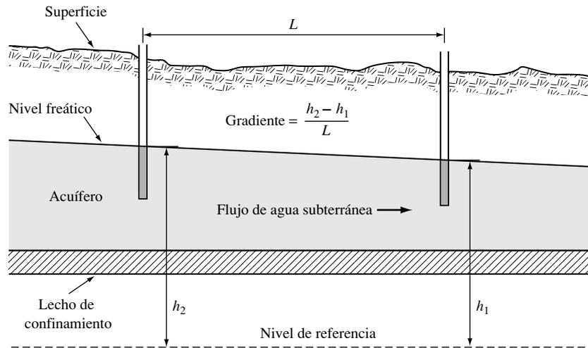
**FIGURA 5.28.** Nivel hidrostático y gradiente en un acuífero libre. El flujo de agua subterránea va de izquierda a derecha en el plano de la página, y el gradiente es  $\Delta h/L$ .
