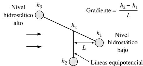
**FIGURA 5.30.** Utilizando tres pozos para determinar el gradiente: dibujamos una recta entre los pozos de mayor y menor nivel hidrostático y hallamos el punto de nivel igual al tercer pozo, que determina una línea equipotencial entre ambos.
