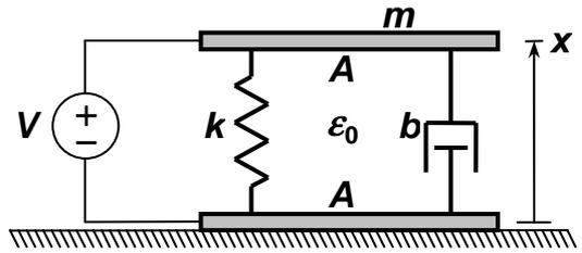
Un resorte de constante de elasticidad  $k$  y un amortiguador de constante de viscosidad  $b$  (aislantes y de volumen despreciable) acoplan ambas placas conductoras. Entre las placas se aplica una diferencia de potencial  $V$ . La posición de la placa superior con respecto a la placa inferior se denota  $x$ . Sea  $x_0$  la posición de equilibrio correspondiente a  $V = 0$  constante.
