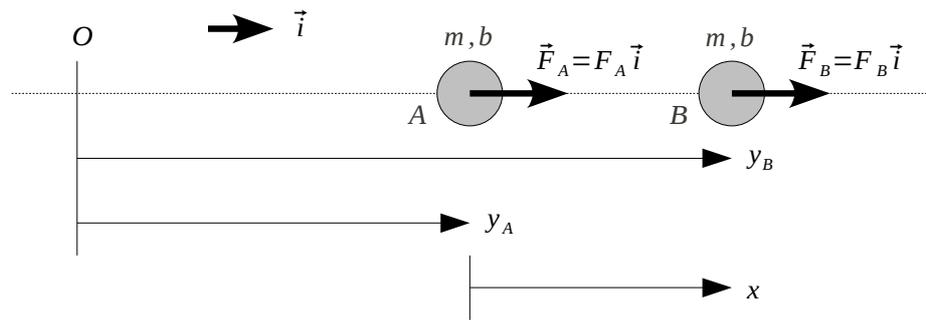
componentes horizontales de las fuerzas que, por acción y reacción, el piso ejerce sobre  $A$  y  $B$  respectivamente; donde  $\vec{i}$  es el versor que se representa en la figura.
