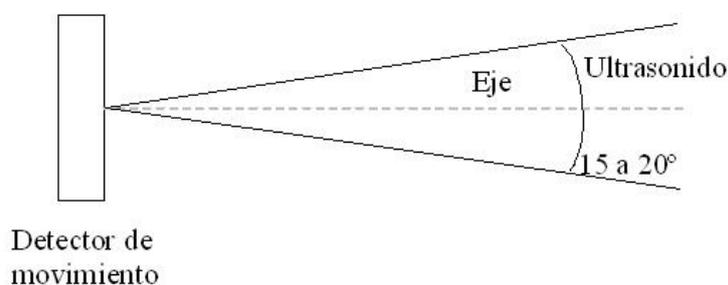
Figura 5: Esquema del detector de movimiento con el cono de ondas de ultrasonido
