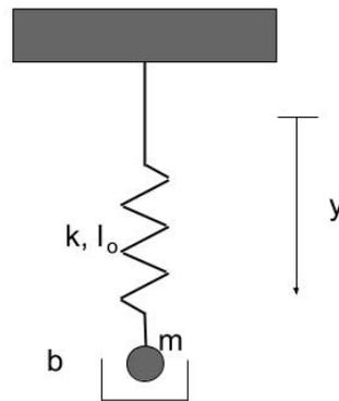
Figura 1: Sistema masa resorte con amortiguamiento
