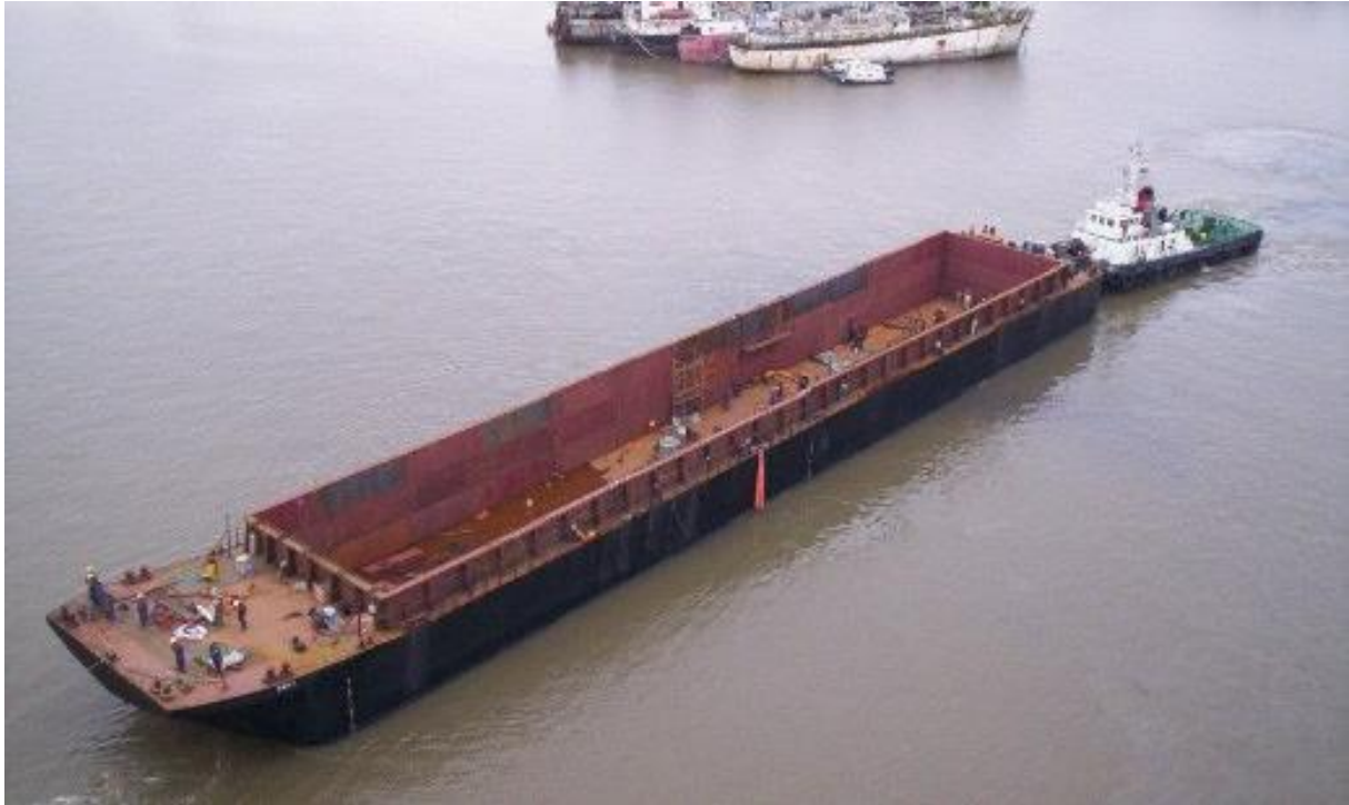
Fig. 27 - Botadura y traslado portuario de la barcaza TFF2 construida para la planta de UPM (ex Botnia)
