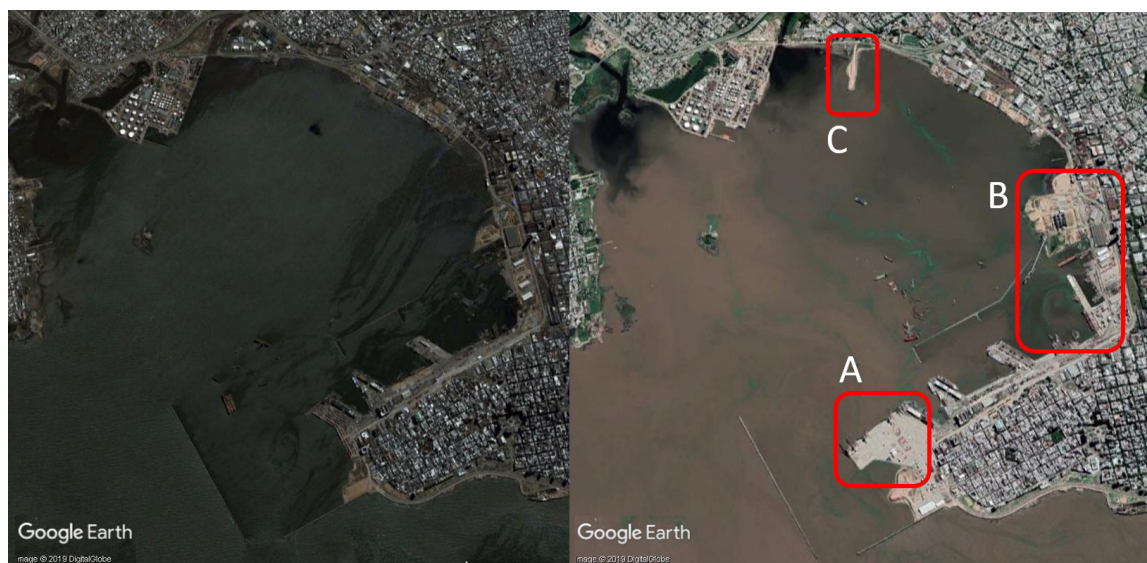
Figura 5. Cambios y transformaciones en la zona portuaria de la Bahía de Montevideo. Imagen izquierda, año 2000; y derecha, año 2016. En este período se destacan las obras portuarias de la playa de contenedores (A), muelles, zona de relleno y terminal granelera (B) y muelle destinado a la actividad pesquera nacional e internacional (C).
