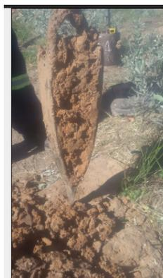
**“TOSCA”. ROCA EN ESTADO DESAGREGADO A FRACTURADO OBTENIDA EN EL “FONDO” DE LOS DIFERENTES CATEOS**
