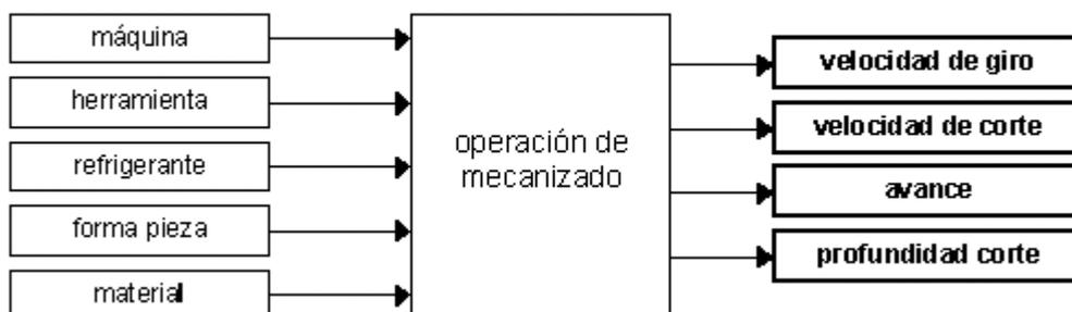
Fig.1: Factores a tener presentes en el mecanizado con MHCN
