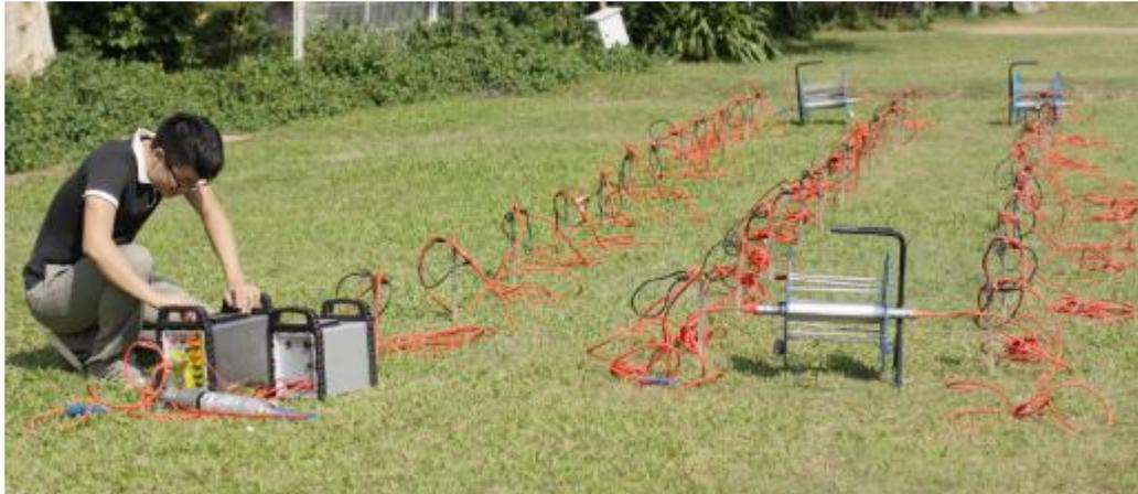
Figura 12. Amado de tomografía eléctrica en campo. Fuente sitio web GEOMATIVE.
