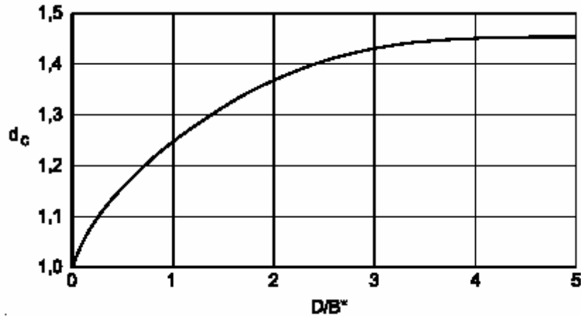
Figura A.2. Coeficiente de corrección ( d_c ) \approx d_c = 1 + 0,34 \cdot \arctg(D/B^*)
