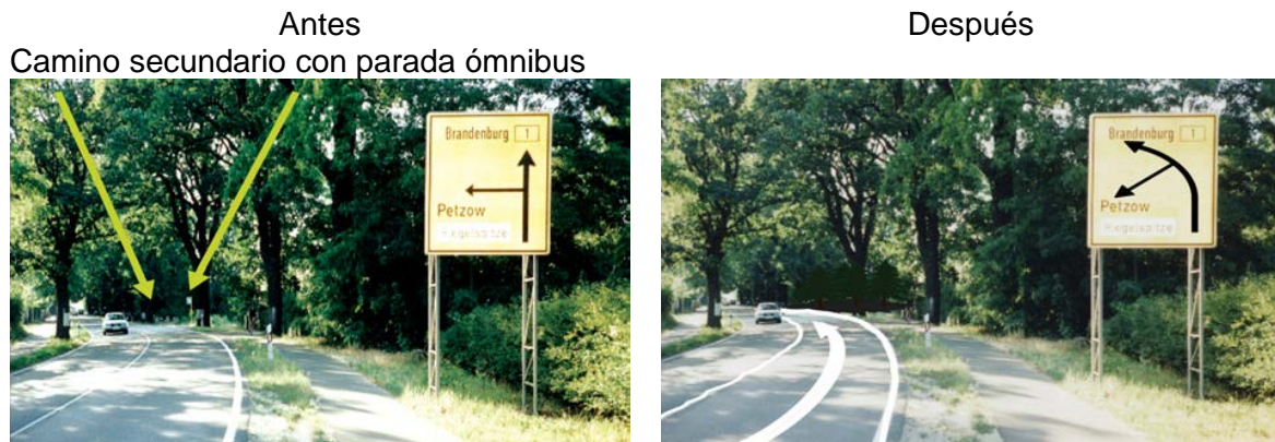
Figura 2.20 Ejemplo – Mala transición. Intersección en curva horizontal
