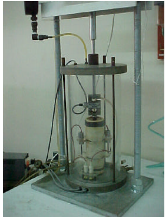
Fotografías 1 y 2: Detalles de la célula triaxial y los captore de deformación.
