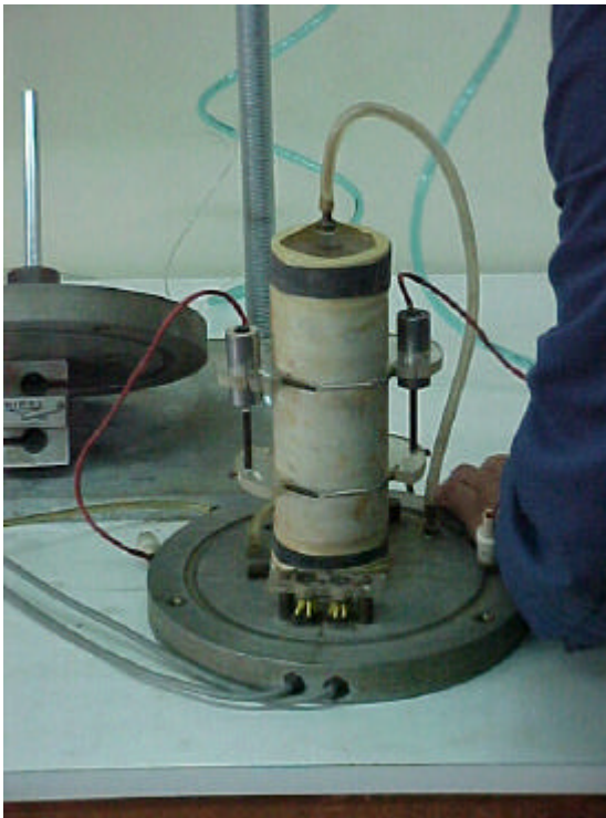
Fotografías 1 y 2: Detalles de la célula triaxial y los captore de deformación.
