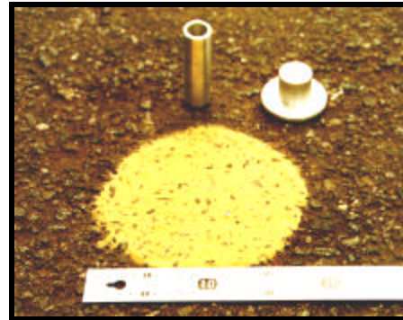
Figura 4. Parche de Arena
