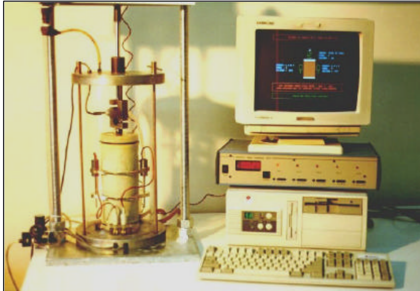
Figura 5. Ensayo de Deformación Plástica de Suelos en Laboratorio, laboratorio Vial IMAE.
