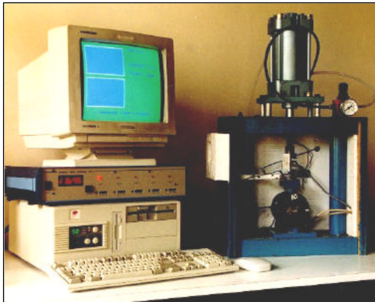
Figura 4. Ensayo de Fatiga en Laboratorio, laboratorio Vial IMAE.
