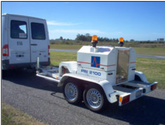
Figura 6. .Deflectómetro a Impacto -Carl Bro Pri 2100 de Vialidad de Santa Fe
