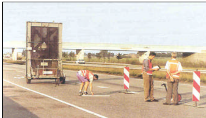
Figura 19. Inspección visual de deterioros
