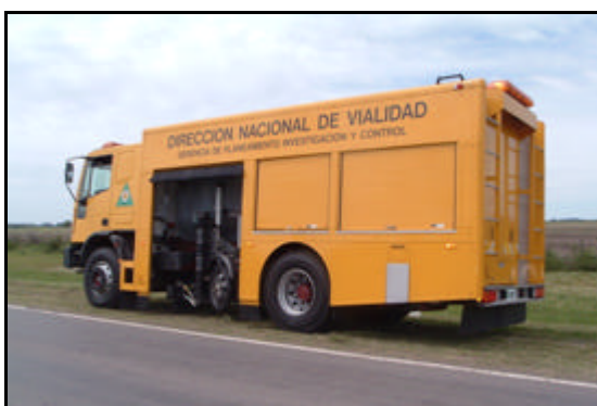
Figura 26. Equipo Scrim Tex, vista general y detalle
