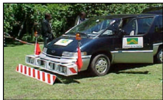
Figura 16. Perfilómetro KJ Law (9 sensores infrarrojo)
