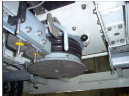
Figura 6. .Deflectómetro a Impacto -Carl Bro Pri 2100 de Vialidad de Santa Fe
