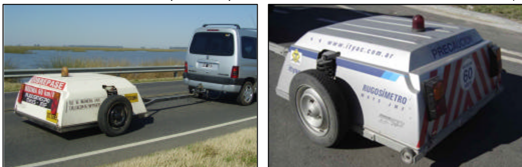
Figura 11. Rugosímetros Mays-JMF de IMAE e ITYAC
