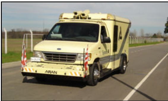
Figura 15. Equipo ARAN (37 sensores ultrasonido)
