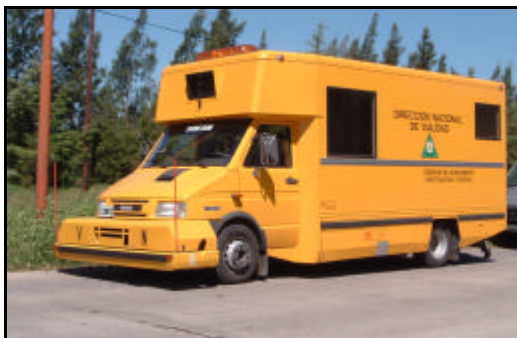
Figura 17. MRM (16 sensores láser)
