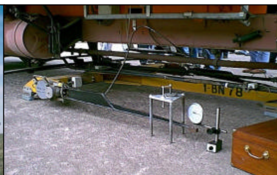
Figura 4. Trineo y palancas medición en posición calibración estática
