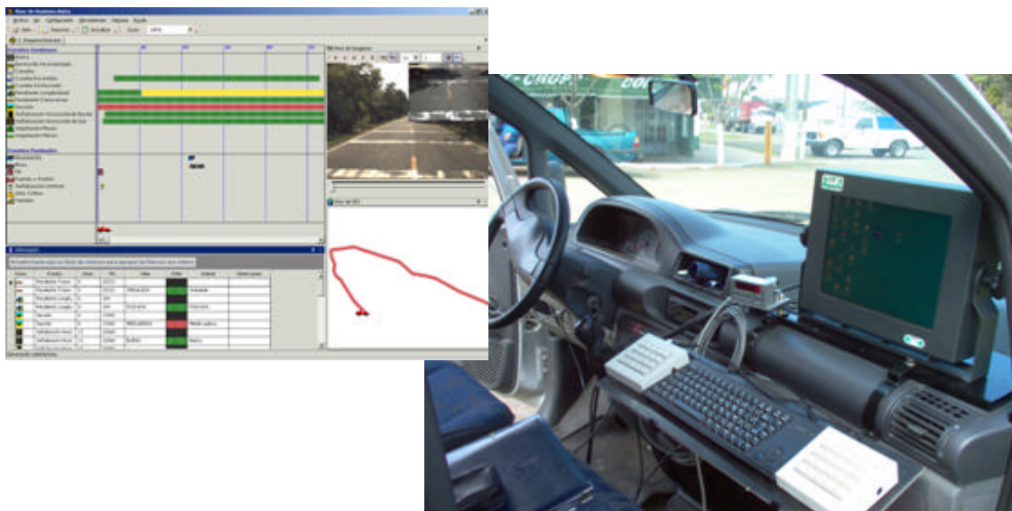
Figura 23: Sistema ASTRA de a bordo: teclados, monitor, odómetro
