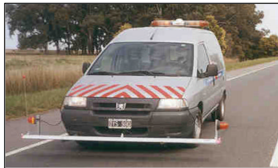
Figura 18. TUS (13 sensores ultrasonido)
