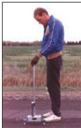
Figura 13. Equipo “Dipstick”, y forma de operación
