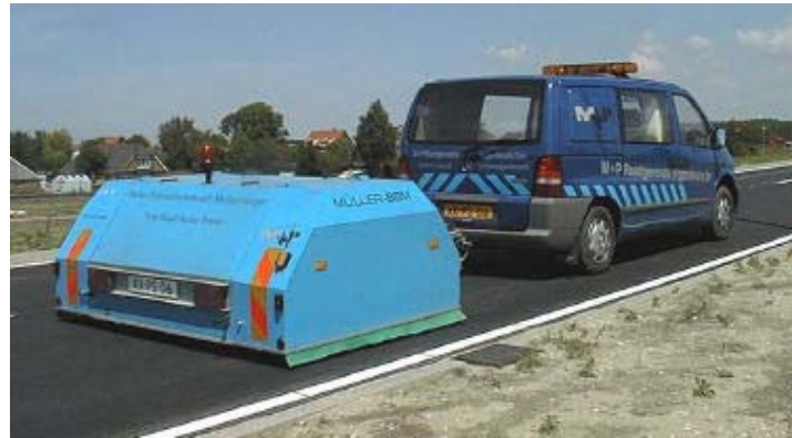
Fig. 12 medidor de ruido Close Proximity (CPX) ISO/DIS-11819-2
