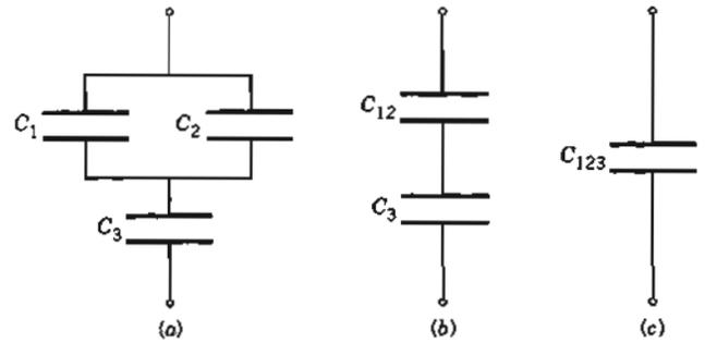
**Figura 7** Problema muestra 5. (a) Combinación de tres capacitores. (b) La combinación en paralelo de  $C_1$  y  $C_2$  se ha reemplazado por su equivalente,  $C_{12}$ . (c) La combinación en serie de  $C_{12}$  y  $C_3$  se ha reemplazado por su equivalente,  $C_{123}$ .
