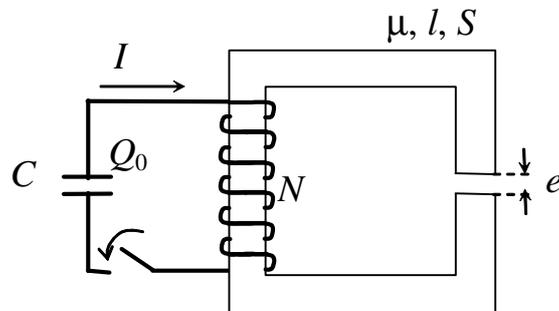
La bobina se puede conectar por medio de una llave a un condensador de capacidad  $C$  que inicialmente, cuando la llave está abierta, está cargado con una carga  $Q_0$  en la placa que se indica en la figura.
