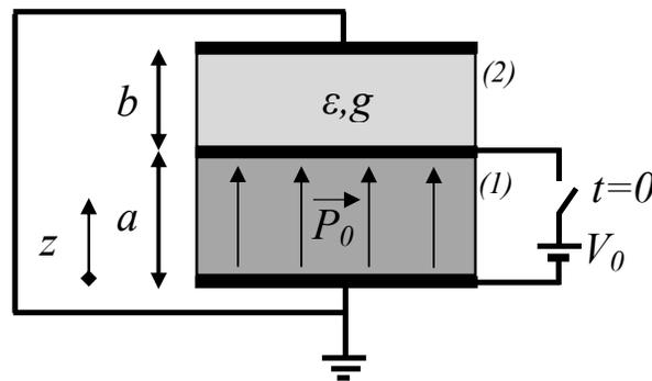
a) determine en las regiones (1) y (2) los campos:  $\vec{E}_1$ ,  $\vec{E}_2$ ,  $\vec{D}_1$ ,  $\vec{D}_2$ , las densidades de corriente:  $\vec{J}_1$ ,  $\vec{J}_2$  y las corrientes:  $I_1$  e  $I_2$ .
