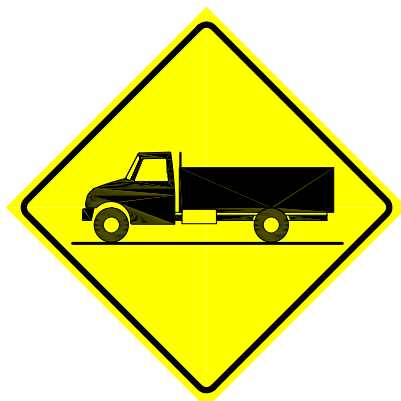
P-46 PASO DE CAMIONES
