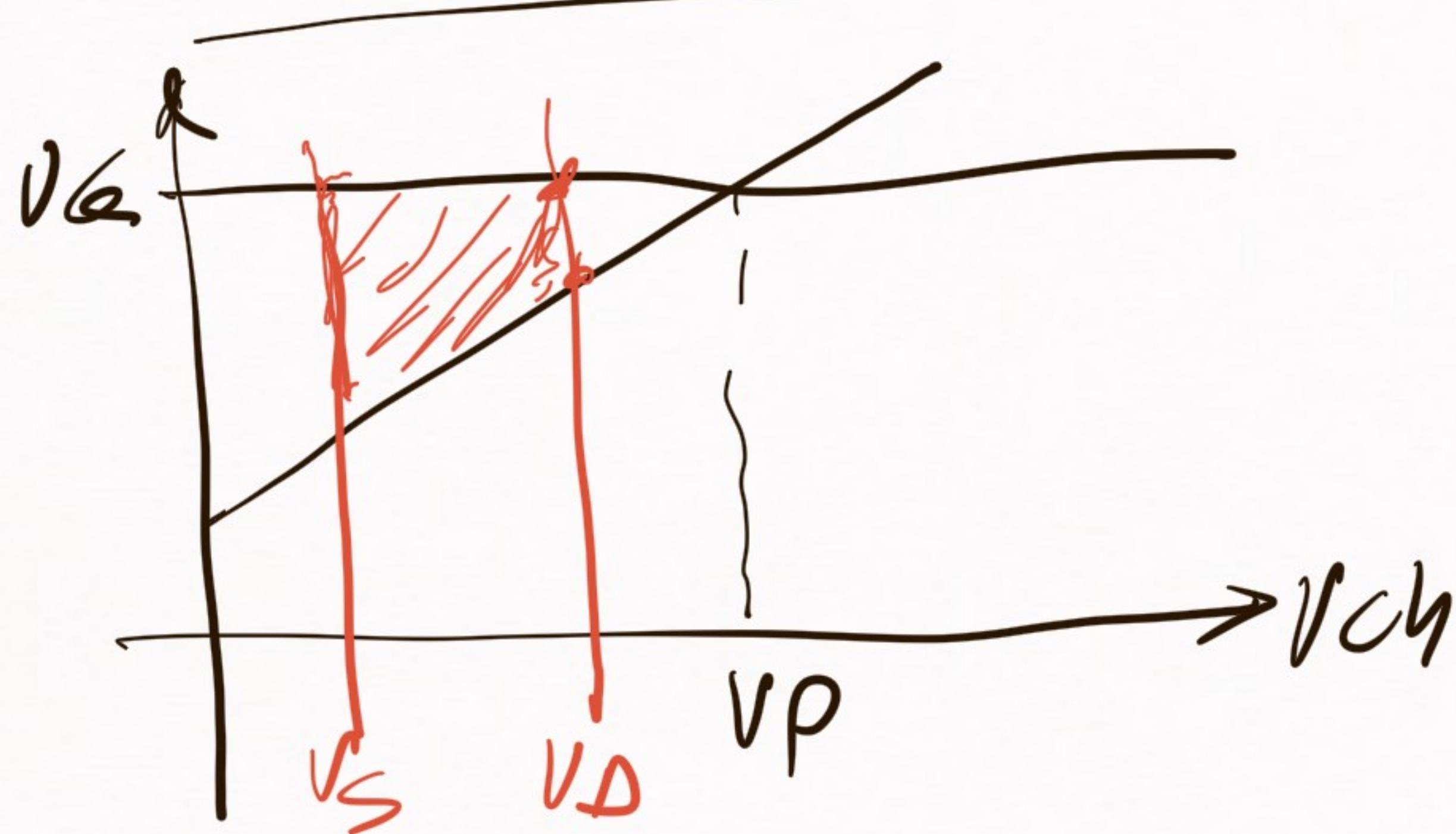
$I_D = \beta$ , área del triángulo
