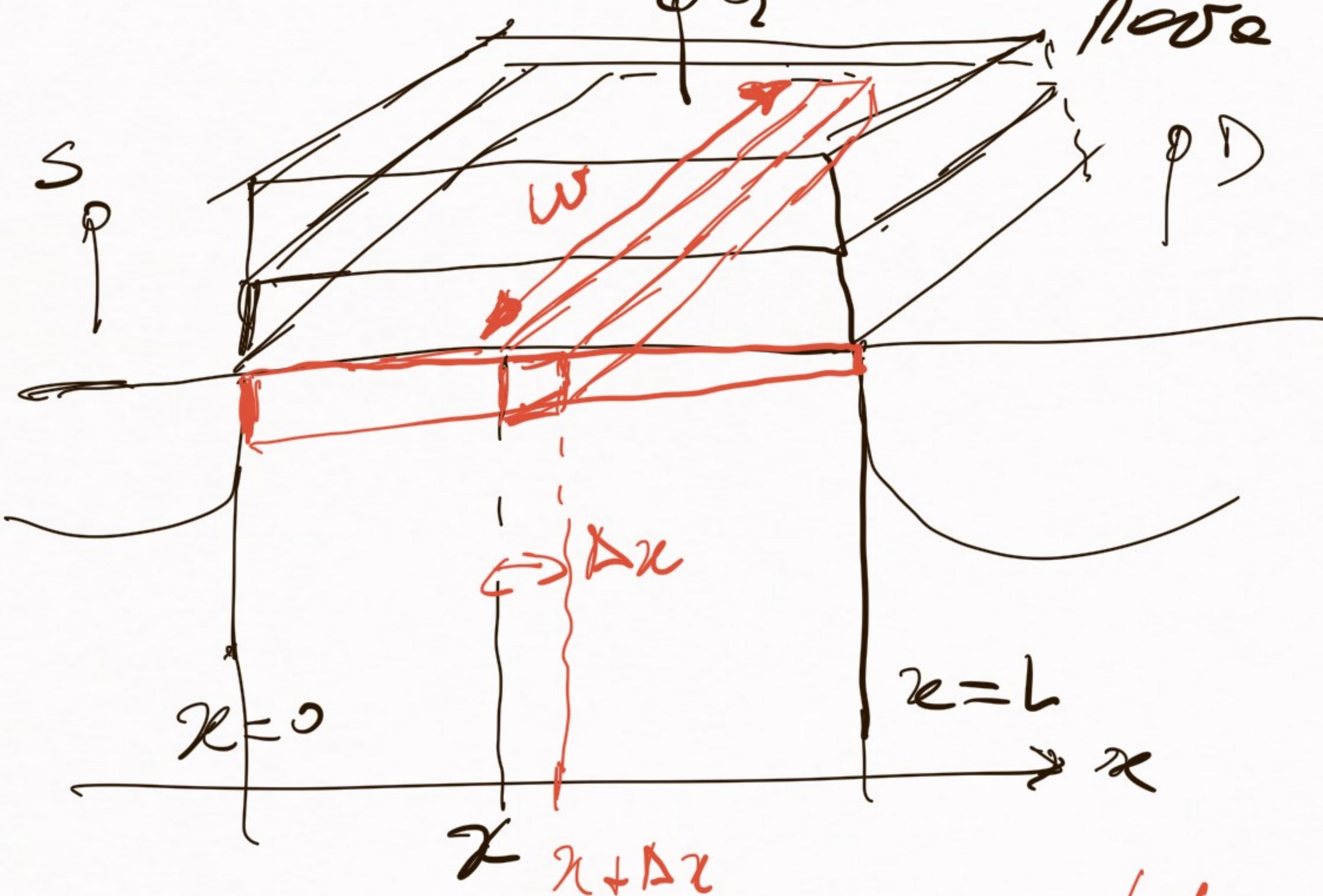
$$Q_{\text{berre entre}} = -w \cdot \Delta x \cdot \text{lx} \cdot (v_s - v_{d0} - (1+\delta)v_{ch}(x))$$
