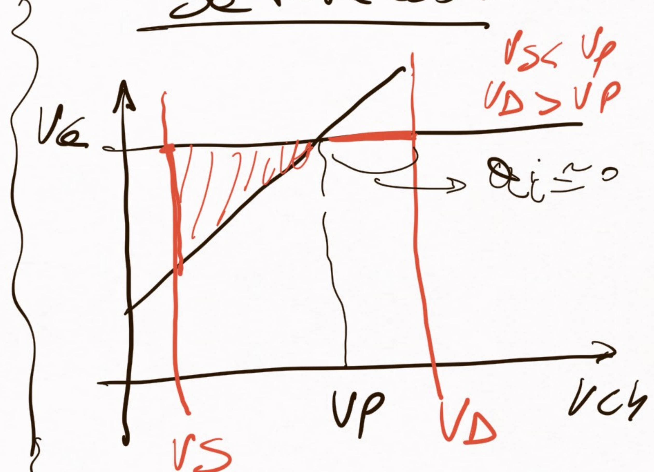
$I_D = \beta$ , área del triángulo
