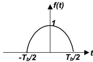
Luego, como se usa codificación polar, se tiene que el 0 se envía con amplitud  $-A$ , mientras el 1 se envía con amplitud  $A$ . La forma que tiene el pulso que representará el 0 y el 1 se muestran en las siguientes figuras.
