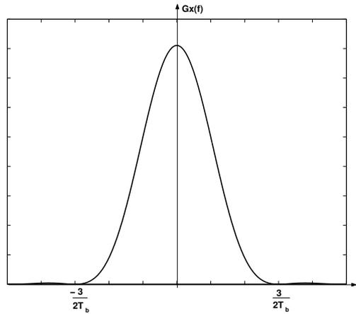
Una aproximación del ancho de banda de la señal transmitida es  $W \approx \frac{3}{2T_b}$
