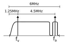
El receptor<sup>1</sup> introduce ruido AWGN, con densidad espectral de potencia  $\frac{\eta}{2}$  con  $\eta = 10^{-14}$  Watt/Hz. Se asume una relación de potencia de transmisión entre la señal de video y la señal de audio de 10:1.
