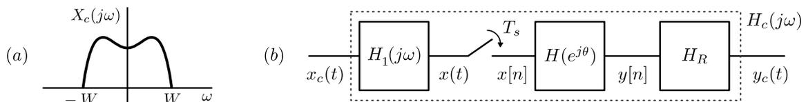
La señal  $x_c(t)$  es muestreada como se muestra en la subfigura (b), obteniendo así la señal de tiempo discreto  $x[n]$ . El período de muestreo es  $T_s = 2/3 T_N$  donde  $T_N = \pi/W$  corresponde a la frecuencia de Nyquist, y  $H_1(j\omega)$  es un filtro para evitar solapamiento (*antialiasing*).
