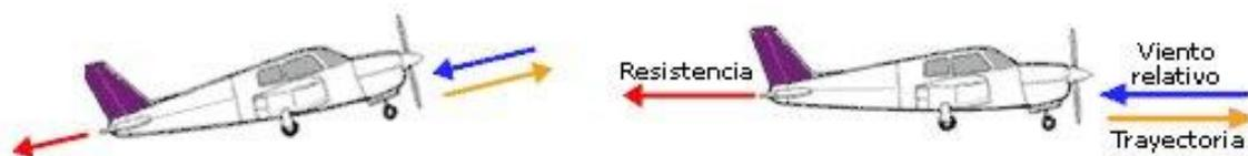
La resistencia por fricción es proporcional a la viscosidad (que en el aire es muy baja), de manera que la mayoría de las veces esta resistencia es pequeña comparada con la producida por la presión, mientras que la resistencia debida a la presión depende de la densidad de la masa de aire.
