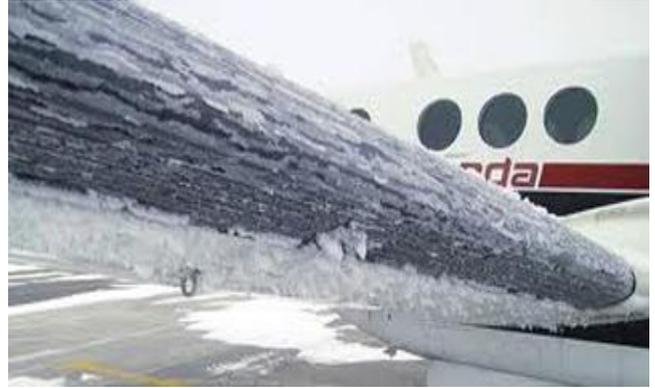
Este fenómeno es muy peligroso, ya que al afectar la superficie alar, modifica su sustentación, ángulo de ataque, peso y demás condiciones, las cuales pueden llegar a provocar que la aeronave entre en pérdida. La interrupción de equipos de medición como el tubo pitot, puede ocasionar graves problemas o incluso graves accidentes, al impedir medir la velocidad del viento.
