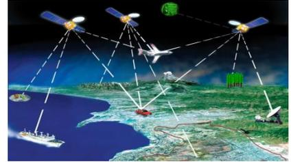
La radionavegación vía satélite, se basa en el cálculo de una posición sobre la superficie terrestre, midiendo las distancias de un mínimo de tres satélites de posición conocida, y un cuarto satélite, aportará además, la altitud. La precisión de las mediciones de distancia, determina la exactitud de la ubicación final.
