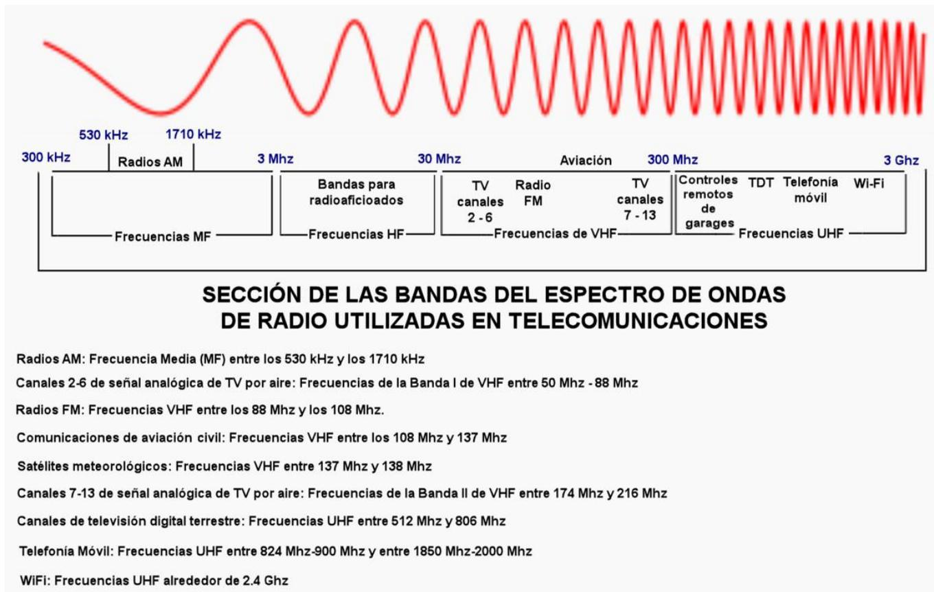
Por lo tanto, usualmente se usan las bajas frecuencias para transmisión de radio, las medias y altas frecuencias para transmisión de radio y televisión, y las frecuencias más altas aún se emplean generalmente para la transmisión de datos, (ya sea de telefonía celular, GPS, enlaces, radares, etc).
