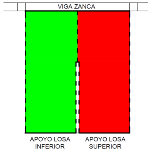
Figura 11-2 . Diagrama esquemático de las losas simplificadas supuestas para cálculo de escaleras de dúplex
