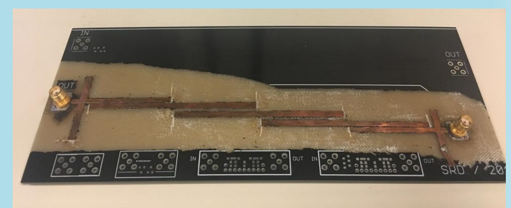
Placa implementada. Arriba filtro + diodos con solder mask. Abajo filtro habiendole quitado el solder mask.
