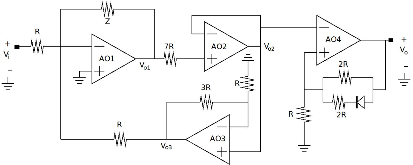
Se considera primero el **subsistema lineal** formado por los amplificadores operacionales 1, 2 y 3, funcionando en régimen sinusoidal.
