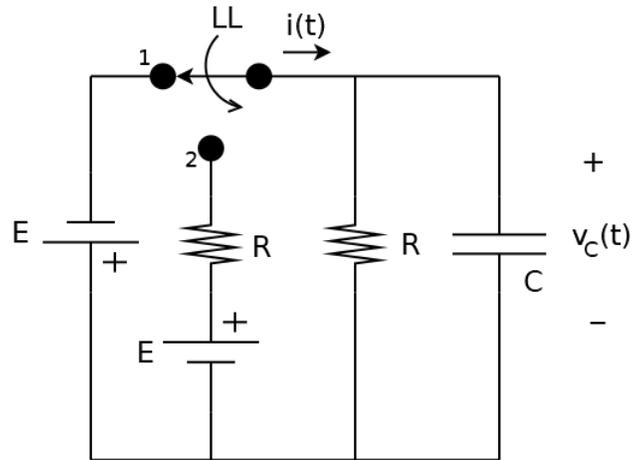
El circuito de la figura se encuentra en régimen de continua cuando conmuta la llave  $LL$ , en el instante que denotaremos por  $t = 0$ . Modelando el circuito en Laplace, hallar  $v_C(t)$  e  $i(t)$  para todo instante positivo.
