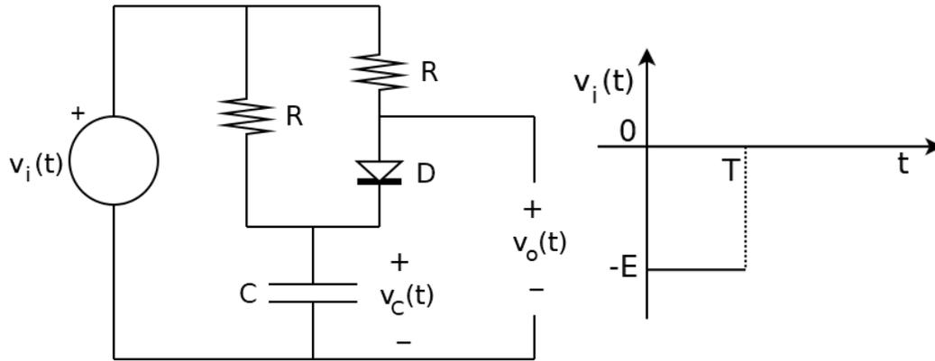
El circuito de la figura, con el condensador inicialmente descargado, se inyecta la señal de la gráfica. Se sabe que  $T = RC$ . Analizando por tramos, hallar las tensiones  $v_C(t)$  y  $v_o(t)$  para todo instante positivo.
