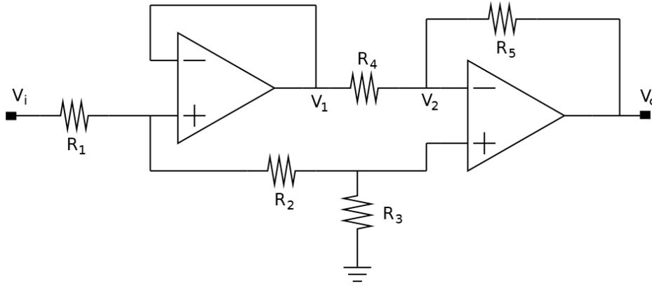
Figura 1: Circuito con amplificadores operacionales
