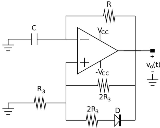
El circuito es un astable. Observemos en primer lugar que la salida del comparador vale  $\pm V_{CC}$ , por lo que la rama que involucra la pata + es similar al circuito de la parte anterior, con  $E = V_{CC}$  y  $R_1 = R_2 = 2R_3$ . Tendremos que si  $v_o = +V_{CC}$ , el diodo está OFF y
