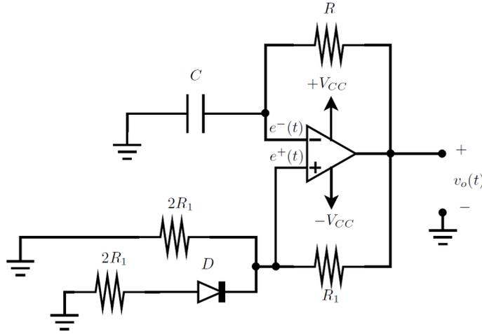
El circuito es un astable. Observemos en primer lugar que la salida del comparador vale  $\pm V_{CC}$ , por lo que la rama que involucra la pata + es similar al circuito de la parte anterior, con  $E = V_{CC}$  y  $R_2 = R_3 = 2R_1$ . Tendremos que si  $v_o = +V_{CC}$ , el diodo está OFF y
