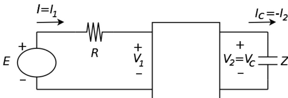
condensador  $Z_C = \frac{1}{Cj\omega}$ , con  $\omega = 100\pi$ . Entonces, la impedancia que ve la fuente en régimen sinusoidal vale  $Z_{eq} = R - \frac{1}{Cj\omega} = R + j\frac{1}{C\omega} = R + jX$ , que es inductiva, pues su reactancia  $X$  es positiva. Trabajamos en valores eficaces.
