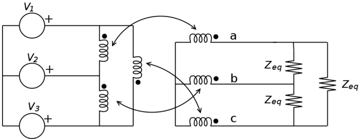
El triángulo de impedancias  $Z_{eq}$  podemos convertirlo en una estrella equivalente de impedancias de valor  $Z_{eq}/3$ . Estas impedancias pasan al primario del transformador trifásico multiplicadas por la relación de transformación al cuadrado y formando un triángulo de impedancias  $\frac{4}{3}Z_{eq}$ . Finalmente, podemos transfigurar este triángulo en una nueva estrella, de impedancias de valor  $\frac{4}{9}Z_{eq}$ . Obtenemos entonces el equivalente monofásico de la figura:
