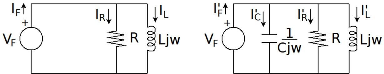
Se considera el circuito en régimen sinusoidal de la izquierda, en el que una fuente alimenta una impedancia que se modela como el paralelo de una resistencia  $R$  y una inductancia  $L$ . Para compensar la potencia reactiva consumida a la fuente, se conecta un condensador como se muestra en la figura de la derecha, de valor  $C$  adecuado.
