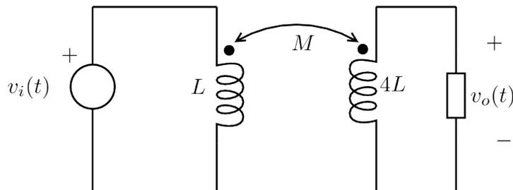
Se considera el transformador **perfecto** de la figura. El primario está alimentado por una fuente sinusoidal y en el secundario se ha conectado una impedancia  $Z$ .
