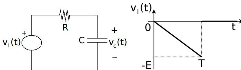
Mirando el circuito, identificamos dos tramos. Un primer tramo entre  $[0, T]$ , donde el circuito está con datos previos nulos y la entrada es una rampa de pendiente  $-E/T$ . Un segundo tramo en el que la entrada es nula y el circuito tiene dato previo no nulo, igual al valor de la tensión del condensador al final del tramo anterior.
