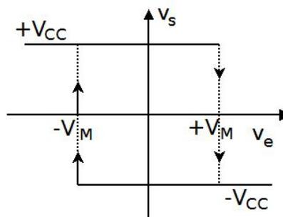
Mirando el diagrama de conmutación del Schmitt trigger, vemos que para generar una conmutación, la entrada tiene que superar  $V_M$  o pasar para abajo de  $-V_M$ . Lo que sabemos de la entrada es que es una senoide de pulsación  $\omega_0$ . Al ser la respuesta en régimen sinusoidal de un sistema lineal de transferencia en régimen  $H(j\omega)$ , la entrada al comparador es:
